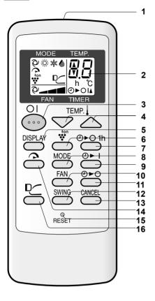
1 信號傳送器 2 顯示器 3 開 / 關按鈕 4 溫度按鈕 5 顯示按鈕 (DISPLAY) 6 PCI 按鈕 7 一小時關機定時器按鈕 8 模式設定按鈕 (MODE) 9 定時開機按鈕 10 風速按鈕 (FAN) 11 定時關機按鈕 12 風擺按鈕 (SWING) 13 定時器取消按鈕 (CANCEL) 14 快速操作按鈕 15 重設按鈕 (RESET) 16 康達氣流按鈕
